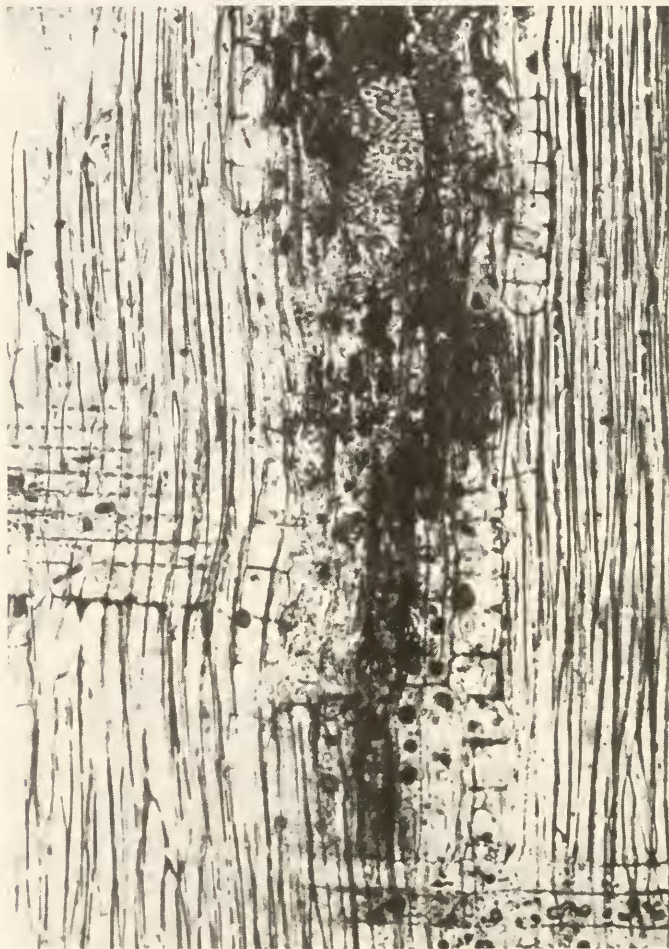
Abb. 9: Radialschliff. Unseptierte Libriformfasern und einige Kristallkammer-Schläuche. Inventar-Nr. BSP 1971 I 57. \times 315 .
